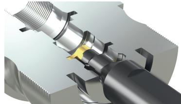
İç çap uygulamalarında kanal açma ve profil tornalama takımlarımızla, kanal açma işlemine ek olarak aynı takımla karmaşık bir kanalın yan kısımlarının profilini de tornalayabilirsiniz.
