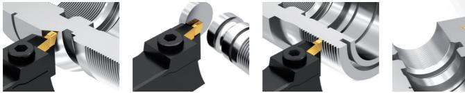
Werkzeugsystem bestehend aus zweischneidiger Hartmetall-Schneidplatte und stabilen Trägerwerkzeugen. Mögliche Stechtiefen bis 26,0 mm bei der Außenbearbeitung.
