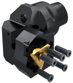
System bestehend aus modularen Grundhaltern und passenden Kassetten für verschiedene simturn Produktgruppen. Die Grundräger mit Polygonschäften nach ISO 26623 sind verfügbar für die Innen- und Außenbearbeitung.
