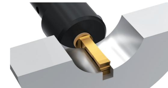
Zwei Werkzeugsysteme für das Nutstoßen von Längsnuten, Innensechskant und weiteren Profilen als Komplettbearbeitung auf geeigneten\* CNC-Maschinen. Reduzieren Sie Haupt- und Nebenzeiten durch die Komplettbearbeitung ohne weiteres Umspannen.
