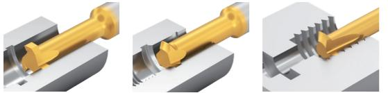
Schaftfräser aus Feinkornhartmetall für die Zirkularfräsbearbeitung von Bohrungen ab Ø 1,4 mm. Verfügbar als drei- und z.T. vierschneidige Variante. Hohe Nuttiefen, sowie hohe Gewindetiefen bei reduziertem Schnittdruck, sind mit diesem Werkzeugsystem möglich.
