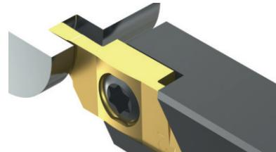
Wendeschneidplatten für das Einstechen und Profildrehen außen mit Schneidenbreiten zwischen 0,5 mm und 3,0 mm, verschiedenen Eckenradien und Schneidengeometrien. Auch als Vollradiuswerkzeuge erhältlich.
