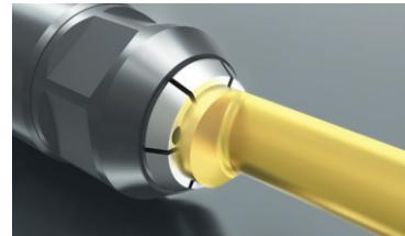
Klemmhalter mit innovativem „ME“-Spannprinzip zum kraftschlüssigen Umspannen des Schneideinsatzes. Vier verschiedene Kühlmittelzufuhrarten (R, L, R+L oder Kühlung durch den Schneideinsatz) je nach Bedarf einstellbar.
