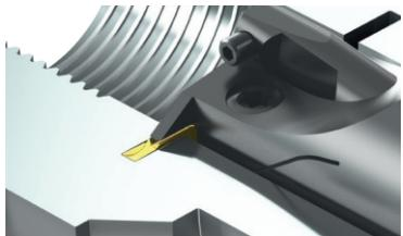
Stechdrehen von Sicherungsringnuten nach DIN 471/472 sowie DIN 983/984. Nutnennbreiten von 1,1 mm bis 4,15 mm im Standard.
