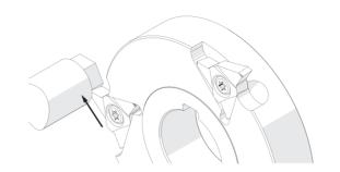
Längsdrehverfahren // Longitudinal feed polygon milling
