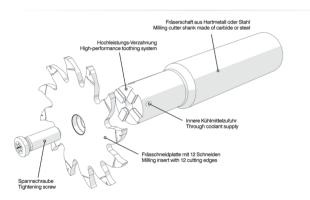
Sechsschneidige Fräswerkzeuge für das Nutfräsen mit Schneidkreisdurchmesser Ø 28 mm und Schneidbreiten von 1,2 mm bis 2,5 mm sowie 12-schneidige Fräswerkzeuge für das Nut-, Trenn- und Schlitzfräsen mit Frästiefen bis zu 16,5 mm und Schneidbreiten ab 0,5 mm und bis 6,0 mm! Eine geschliffene Hochleistungs-Verzahnung sorgt für eine hohe Drehmomentübertragung und eine lange Lebensdauer bei maximaler Flexibilität.
