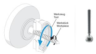
Werkzeuggruppe für das Gewindewirbeln in der Medizintechnik, der allgemeinen Serienteilfertigung und bei schwer spanbaren Materialien. System bestehend aus hochpräzisen, dreischneidigen Hartmetall-Wendeschneidplatten mit ausgesuchten Beschichtungen und passenden Wirbelringen für verschiedene Maschinen und Aggregate.
