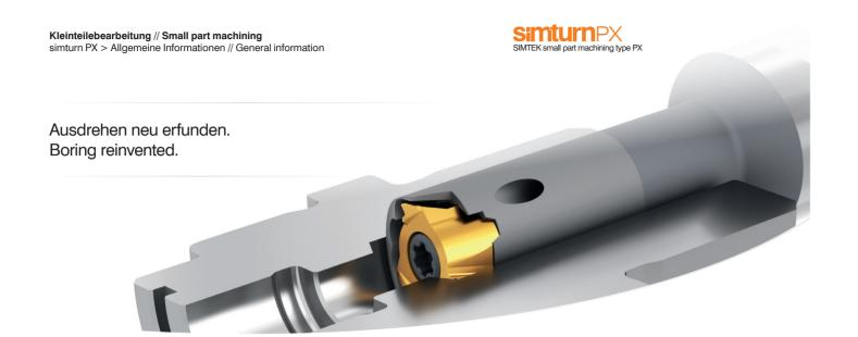
Innovatives Werkzeugssystem für das Ausdrehen von Bohrungen ab Ø 7,8 mm bestehend aus dreischneidigen Wendeschneidplatten mit verschiedenen Schneidengeometrien sowie schwingungsgedämpften Hartmetallschäften oder Stahlschäften mit innerer Kühlmittelzufuhr.
