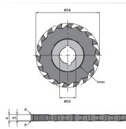
Hochleistungs-Scheibenfräser aus Vollhartmetall mit Schneidkreisdurchmessern Ø 63,0 mm und Ø 50,0 mm für das allgemeine Nutfräsen mit Frästiefen bis zu 15.0 mm.
