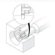
System bestehend aus schwingungsgedämpften Hartmetall- oder Stahl-Fräserschäften und stirnseitig verschraubter Hartmetall- Frässchneidplatte mit 6 Schneiden.
