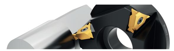
Werkzeugsystem aus drei- oder sechsschneidigen Hartmetall-Wendeschneidplatten und Scheibenfräsern mit mehreren Plattensitzen für das Mehrkantfräsen im Längs- oder Stechdrehverfahren.
