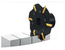
Die präzisionsgeschliffenen simmill H2 Wendeschneidplatten mit zwei Schneiden bieten, in Kombination mit dem aktiven und einfach zu handhabenden Spannsystem, eine sehr hohe Prozessicherheit und eine sehr gute Plan- und Rundlaufgenauigkeit. Maximal mögliche Frästiefe von bis zu 18,0 mm bei einem Schneidkreis von 100,0 mm.
