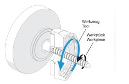
Werkzeuggruppe aus hochpräzisen, zweischneidigen Hartmetall-Wendeschneidplatten mit ausgesuchten Beschichtungen und präzisen Wirbelringen. Besonders geeignet auch für schwer spanbare Materialien
